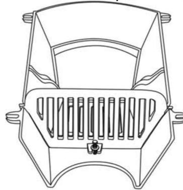
Положите камин на дровник на ровную поверхность. Поместите огнеупорный камень на место и затем вставьте болт в отверстие прямо под ним. Вставьте колосник в пазы топливника над гайкой М6. Закрепите с помощью шайбы М6 и болта М6.
