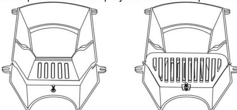
Положите камин на дровник на ровную поверхность. Поместите огнеупорный камень на место и затем вставьте болт в отверстие прямо под ним. Вставьте колосник в пазы топливника над гайкой М6. Закрепите с помощью шайбы М6 и болта М6.
