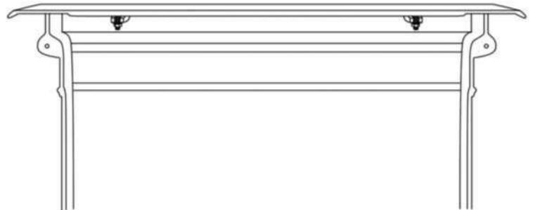
Вид сзади с прикрепленной каминной полкой. Положите полку на пол. Сначала вставьте два винта М6, чтобы они попадали в отверстия двух шайб М6 и затем навинтите две гайки М6 на два винта М6. Положите каминную полку на камин и вставьте два винта М6 в отверстия на полке таким образом, чтобы они проходили через крепежные выступы (рис.3). Для закрепления каминной полки следует использовать плоскую отвертку. Затяните и закрепите с помощью двух гаек М6.
