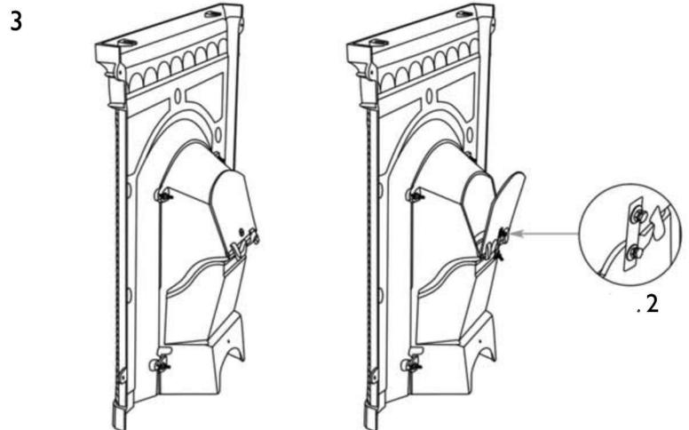
Использование твердого топлива: вставьте заслонку в пазы с обратной стороны топливника. При горении дров заслонка всегда должна быть открыта. Для этого используйте набор деталей для крепежа заслонки. Навинтите гайку М6 полностью на болт М6 и только затем 2 шайбы М6. Зафиксируйте пластину для крепления заслонки (рис.2).
