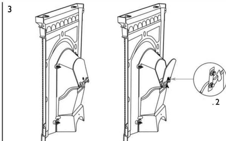
Использование твердого топлива: вставьте заслонку в пазы с обратной стороны топливника. При горении дров заслонка всегда должна быть открыта. Для этого используйте набор деталей для крепежа заслонки. Навинтите гайку M6 полностью на болт M6 и только затем 2 шайбы M6. Зафиксируйте пластину для крепления заслонки (рис.2).
