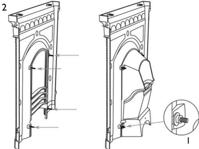
Вставьте 4 гайки М6 с обратной стороны портала. Прикрепите топливник сзади портала, убедившись что гайки М6 проходят через крепежные скобы с обратной стороны топливника. Закрепите и затяните, используя 4 шайбы и 4 гайки М6.
